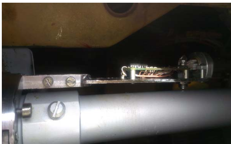
Рис. 2. Фото Установки макета электронного блока для проверки излома валов трансмиссии на вертолете МИ-17
