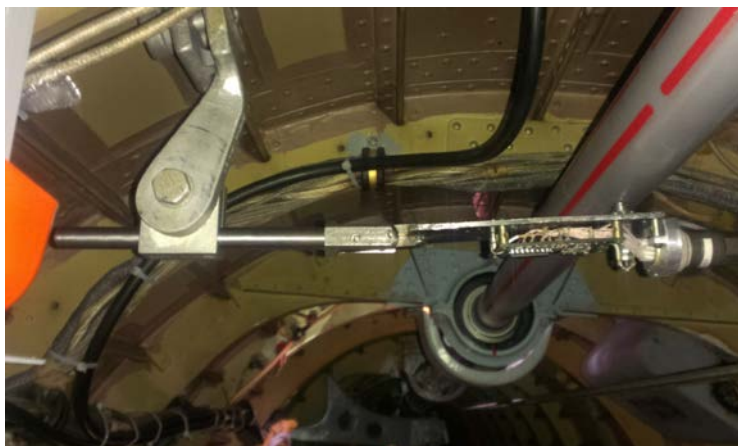
Рис. 1. Фото Установки макета электронного блока для проверки биений валов трансмиссии
